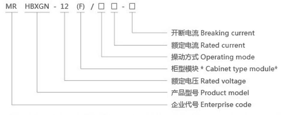
备注:\*MRHBXGN-12通用柜型模块有:C—负荷开关模块;V—真空断路器模块;F—负荷开关-熔断器组合电器模块。
